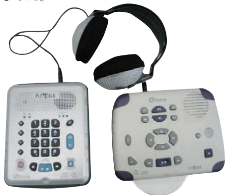
DAISY 図書再生機の例 (右は再生専用、左は録音等もできる多機能な機種)
