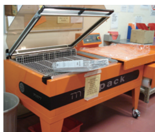
ニュージーランドとオーストラリアでは、原紙はシュリンクラップで複数号まとめてラップして保管しています(右)。誰でも簡単に操作でき(上)、製本するよりはるかに安価です。また欠号の追加や書庫スペースにあわせてラップし直すことも容易で、害虫も防げます。(SLNSW)
