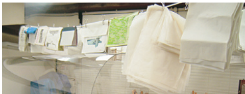
写真4 ドーム（アクリル製）により、送風をうながす
