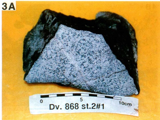
写真 3A 花崗岩質岩の角礫の薄いマンガン酸化物被覆 Photo 3A Very thin manganese oxide coating on an angular granitic rock.
