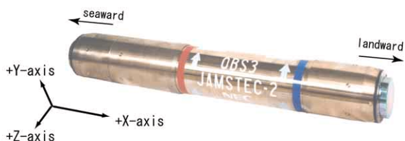
写真1 釧路システム海底地震計の外觀。3本の矢印は海底地震計内部の3成分の向きを示す。
