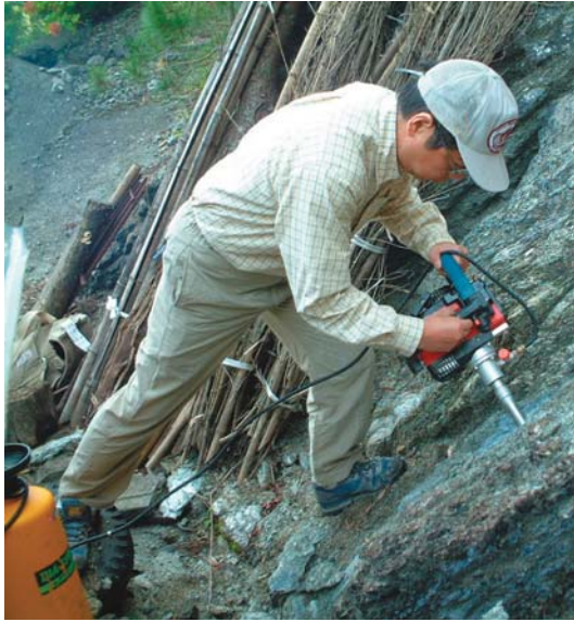
図3-1 高階野にて 岩石ドリルによるサンプリング風景 Fig. 3-1 Takashinano site.
