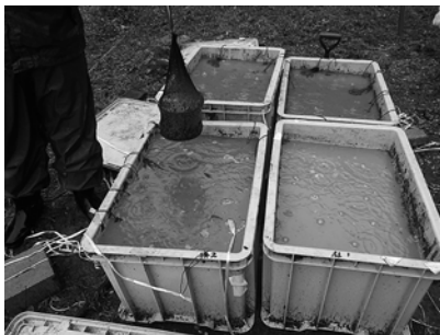
図7. 簡便な60 Lコンテナでの高放射能汚染土壤の除染. 4基で約200 kg土壤が除染可能. 光合成細菌ビーズ袋を1基あたり約10袋投入，好気暗条件で約14日処理. 初期栄養塩（グルコース，ペプトン，ビタミン液）を添加. グルコースは1-4日おきに添加.
