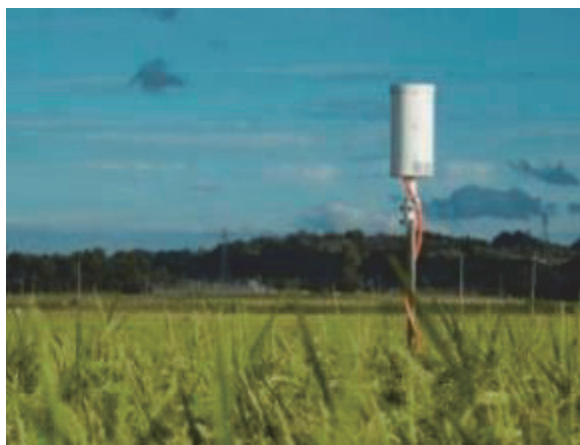
図9 水田に設置されたIoT センサーポール
