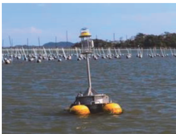
図8 養殖場に設置されたIoT センサーブイ
