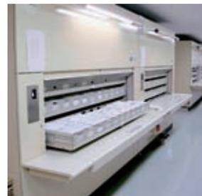
この自動書庫は、地下4階と地下3階の一部を吹き抜けにしてスペースを確保しており、奥行き120m、幅15m、高さ7mのスペースに約2万8千個のコンテナが収納されています。コンテナ1個に約50冊の資料を収蔵できるため、この自動書庫だけで140万冊の収蔵能力があり、省スペースでありながらも大規模な収蔵を可能にしています。
