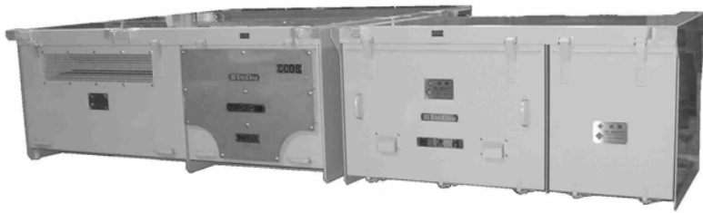
図3 インバータ装置・断流器箱外観
