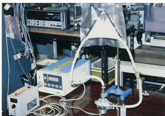
図2 遠心血液ポンプの溶血試験
