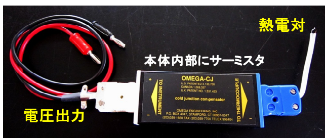
図6. 市販の補償式基準接点の例
