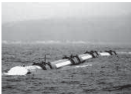
図8 可動物体型波力発電システムの例（Pelamis波力発電装置、浮体式）
