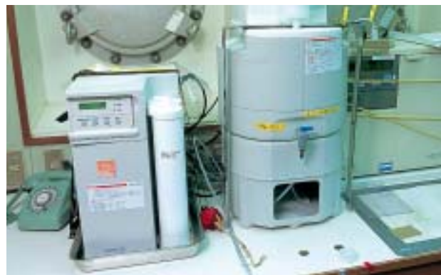
海底で調査する「しんかい6500」と“音話”するための装置。受話器を通じた海底～船上のやりとりはかなり鮮明だという
