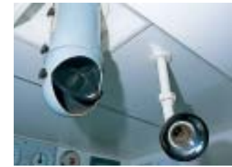
ハイテク化の進んだ船舶だが、人の判断に頼る際の装備も残る。左はマグネットコンパス。右は音声伝令用のパイプ
