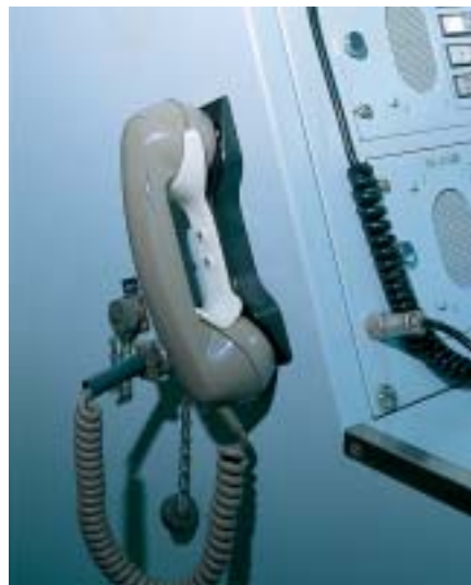
海底で調査する「しんかい6500」と“音話”するための装置。受話器を通じた海底～船上のやりとりはかなり鮮明だという
