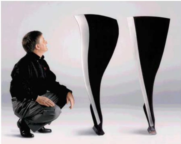
第 7 図 GE90 ファンブレード ( GE 社担当, 左 : 115B, 右 : 94B ) Fig. 7 GE90 fan blade ( GE, left : 115B, right : 94B )
