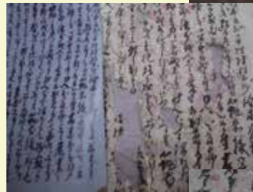
破片を並べた上から不織布で補強し、漉きばめ機で補修。紙の繊維が隙間に入り、不織布をはがすと破片がつかまっている。
