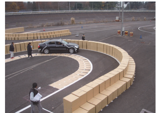
写真 2-7 実験コース②-1（片側壁あり：大型乗用車）
