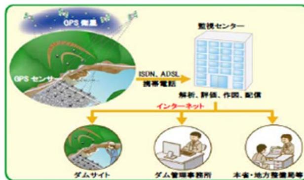
図22-3-9 GNSS ダム変形計測システム概念図
