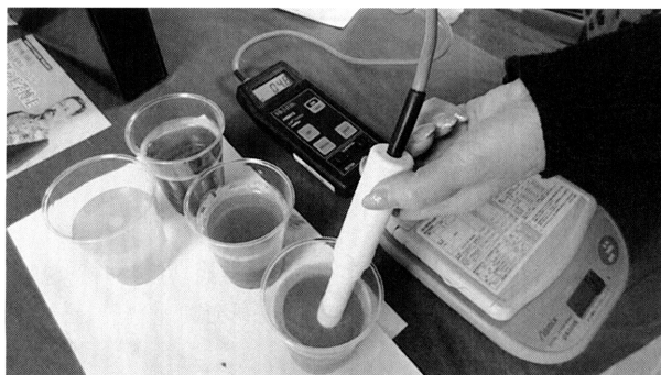
写真一8 土壤サンプルのpH値計測の様子
