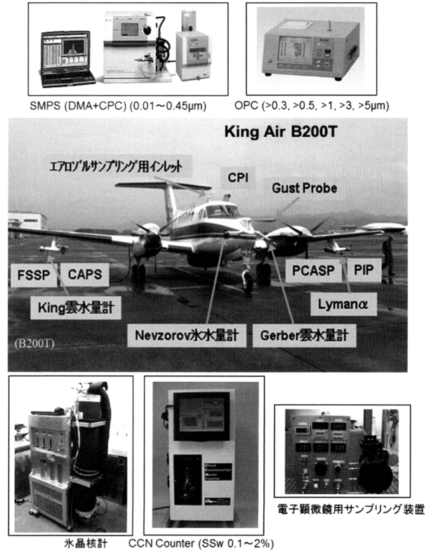
第4図 エアロゾル・雲・降水観測用航空機に搭載される測定装置。氷晶核計は気象研究所で開発（Saito et al. 2011）。
