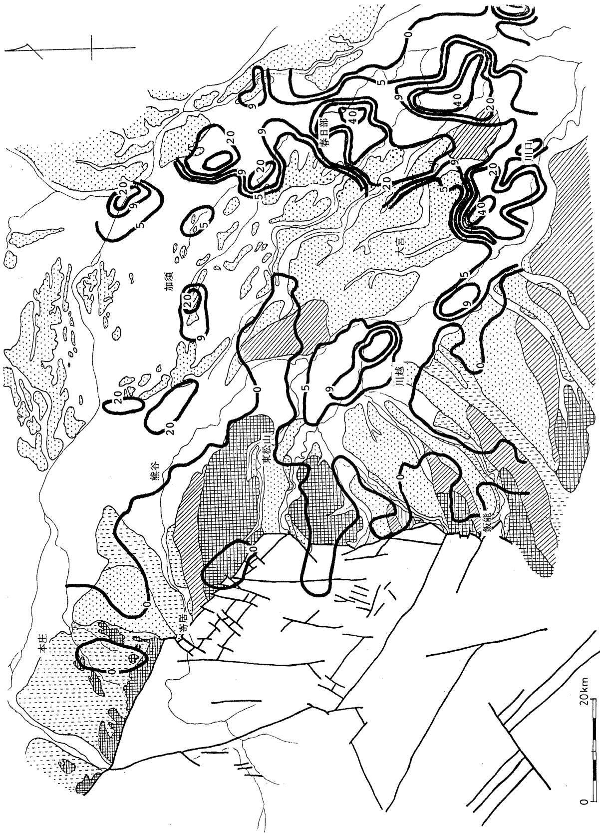
第14図 「関東地震」の家屋倒壊率と地形および地質の区分との関係 数字は倒壊率(%). 地形と地質の区分は第7図と同じ.
