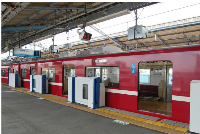
図 10 三浦海岸駅に試行導入されたマルチドア対応ホームドア（車両が3扉の場合）
