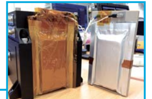
ほどよし3号機技術実証モジュールに搭載された石川教授らが開発したイオン液体リチウム二次電池
