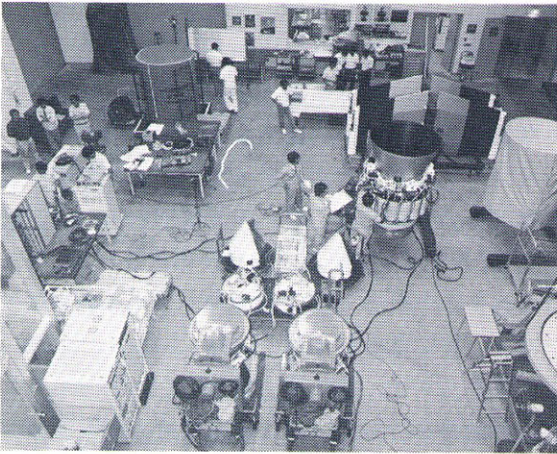
写真1 M-13TVC部及びSB・MNTVC部の噛み合わせ試験
