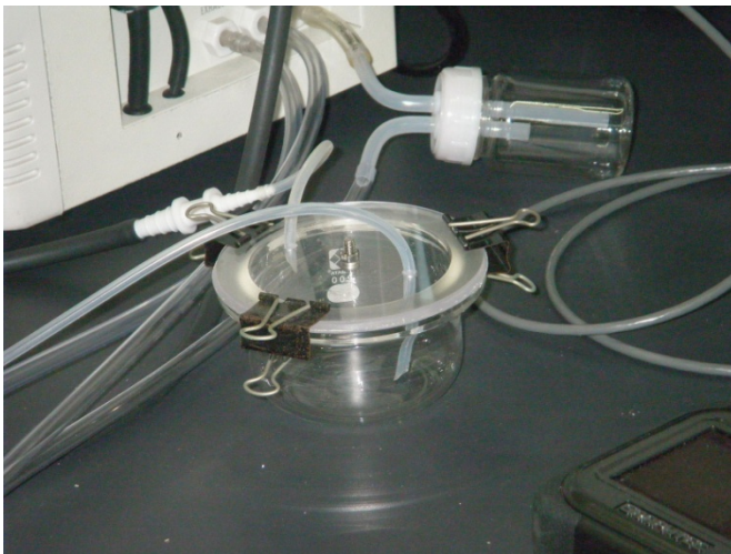
Fig.5 シリンジからセパラブルフラスコにサンプルガスを導入
