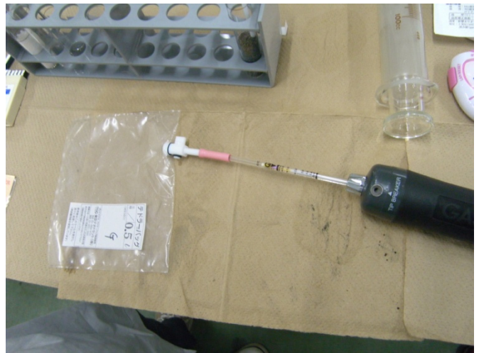
Fig.4 テドラーバックから検知管にサンプルガスを導入
