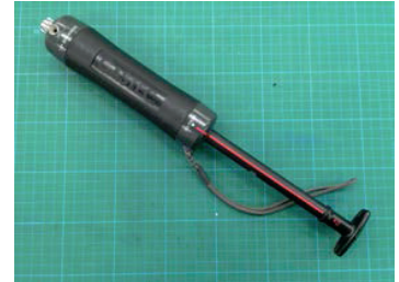
ガステック GV-100型気体採取器 重量約250g、内容積100ml
