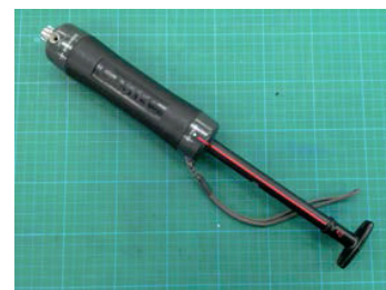
ガステック GV-100型気体採取器 重量約250g、内容積100ml
