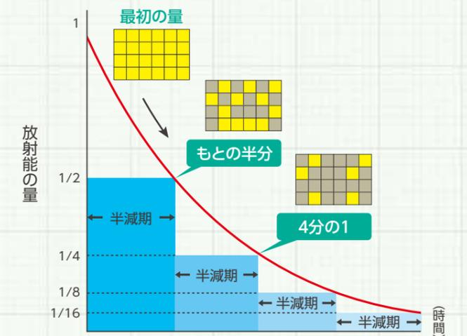
図3/放射能の強さの減り方 参考:原子力・エネルギー図面集2013
