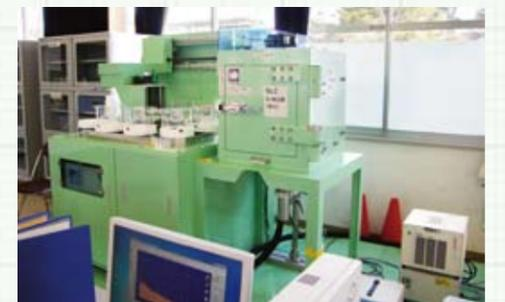
精密型放射能測定器(ゲルマニウム半導体検出器)
