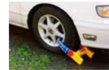
自動車タイヤロック (差し押えた自動車の使用を制限する場合などに装着します。)
