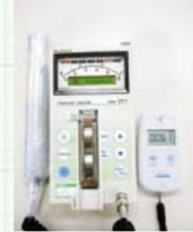
定点測定で使用する放射線測定器の例 左:NaIシンチレーション式サーベイメータ 右:簡易型放射線測定器
