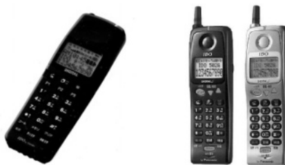
写真5.2 左：IDO初のデジタル携帯機 (D301: KDDI提供) 右：9.6kbps高速データ携帯機 (502G)
