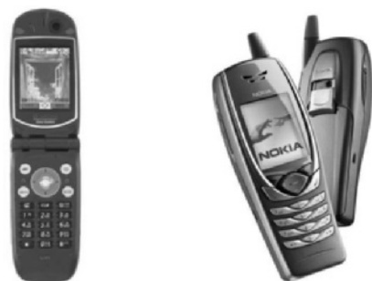
写真6.7 3G（W-CDMA方式）/GSMデュアルモード携帯電話機「V-N701」（左）、Nokia 6650（右）〔ポータフォン〕
