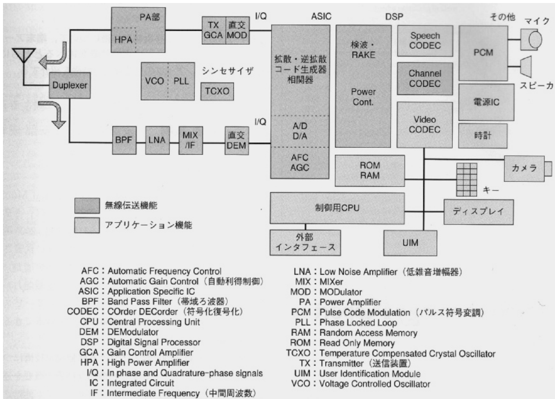
図6.2 W-CDMA 移動端末のハードウェア構成例 7
