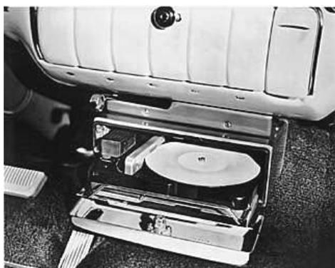
図6.2 車載用レコードプレーヤー（XLPレコード）<sup>2)</sup>
