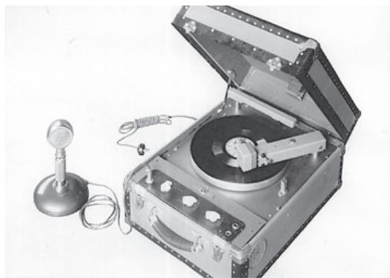
図 4.8 民生用ポータブル円盤録音機の外観 DENON RC-1 型
