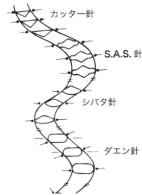
図 5.40 再生針の先端形状と接触面積の関係
