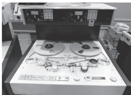
図 5.14 スイスチューダー社 A80 カッティング用 2 トラック再生機の外観
