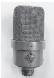
図5.6 独Telefunken社M49コンデンサーマイクロフォンの外観（日本コロムビア株式会社所蔵）
