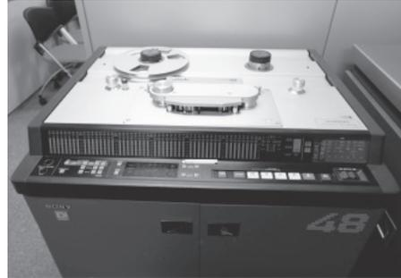
図 5.34 ソニーPCM-3348、48トラックPCMデジタル録音機の外観 (日本コロムビア株式会社所蔵)
