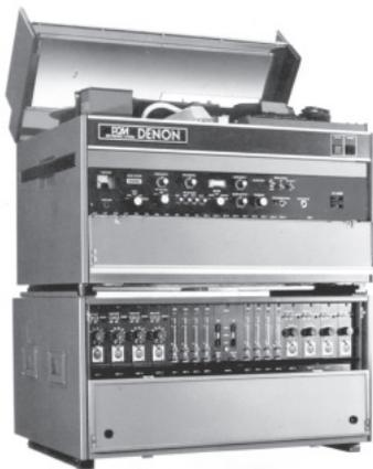
図 5.29 1970年代後半のニューヨーク他でのマルチトラック録音で活躍したDENON DN-034R 8チャンネルPCM/ デジタル録音機 (日本コロムビア株式会社所蔵)
