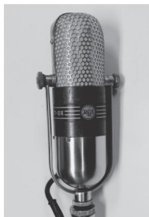
図 5.4 RCA 社 77DX 型マイクロフォンの正面外観
