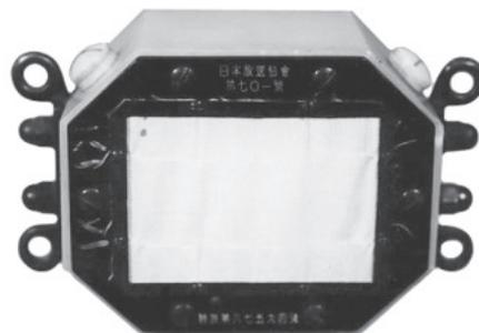
図5.1 純国産のライツマイクロフォン“MHマイクロフォン”の外観（NHK放送博物館所蔵）
