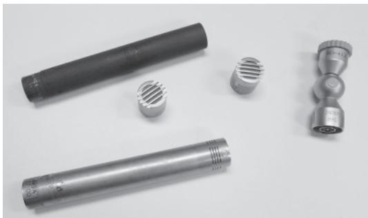
図 5.10 独 Schoeps 社の反射の異なるコンデンサーマイクロフォン等の外観（日本コロムビア株式会社所蔵）
