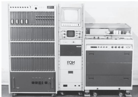
図 5.23 世界最初のレコードマスター用PCM/デジタル録音機(1972年)
