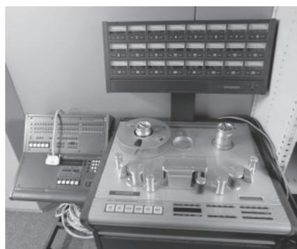
図 5.15 スイスチューダー社 A827 型 24 トラックアナログ録音機の外観
