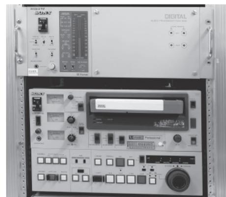
図 5.30 SONY Digital Audio Processor PCM-1630 (上部) とUマチックVTR (下部) (日本コロムビア株式会社所蔵)
