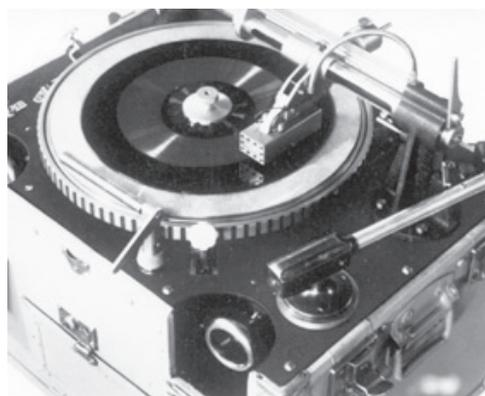
図 4.5 DENON TPR. 14C 型円盤録音機の機構部
