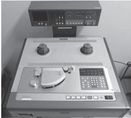
図 5.32 ソニー2トラック固定ヘッドデジタル録音機 3402の外観 (日本コロムビア株式会社所蔵)
