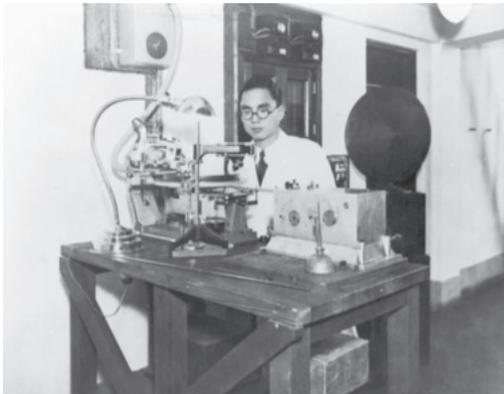
図 5.49 WAX 盤時代の DENON 製カッティングレース
