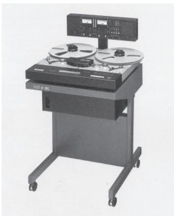
図 5.33 三菱電機の2トラック固定ヘッドデジタル録音機の外観 (日本コロムビア株式会社所蔵)
