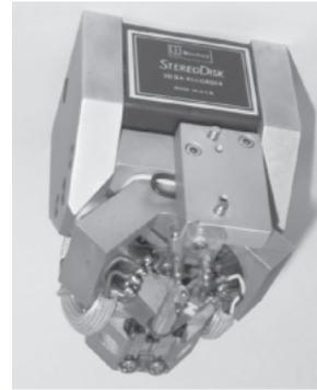
図 5.46 Westrex 3D カッターヘッドの外観
