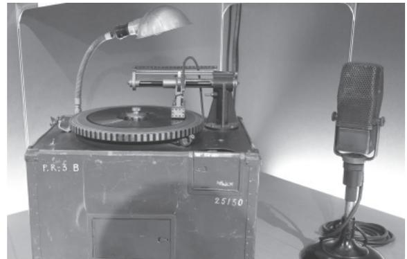
図 4.6 1945 年 (昭和 20 年) 8 月 15 日、終戦の詔勅放送に使われたと同型の円盤録音再生機とマイクロフォン (録音再生機の右側、東京電気製 A 型マイクロフォン) (NHK 放送博物館所蔵)
