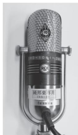
図 5.5 RCA 社 77DX 型マイクロフォンの背面外観
