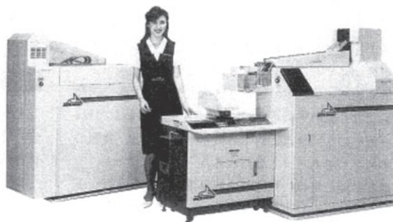
図 7.20 無水洗処理搭載のコニカナイスプリントシステム
