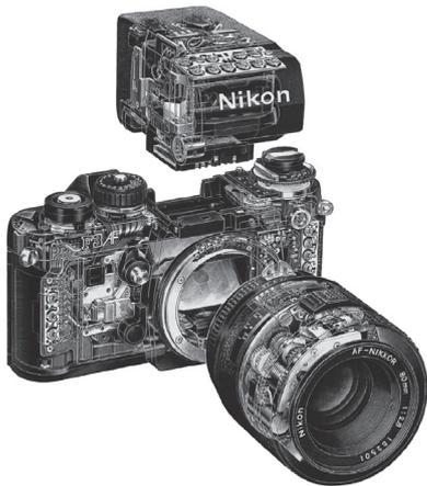
図 6-21 ニコン F3AF 透視図<sup>22)</sup>
