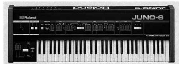
図 3.3.16 ローランド初の DCO 搭載シンセサイザー JUNO-6 (1982年) 当時の価格は 169,000 円 (物品税含む)
