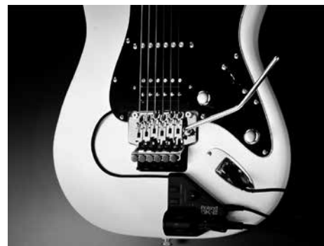
図 4.6.6 ディバイデッド・ピックアップ (ローランド GK-2 取り付け例)
