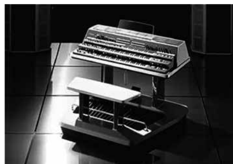
図 2.7.2 ヤマハ GX-1 (1975年) 音源部にはヤマハ初のポリフォニックシンセサイザーが採用された
