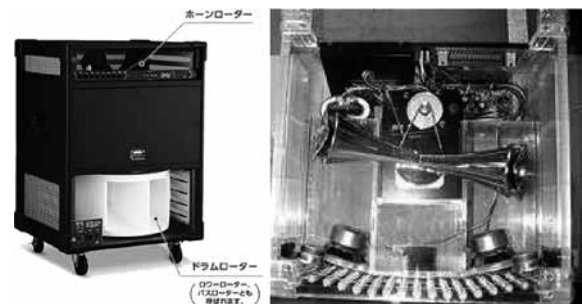
図 4.4.20 ハモンド・スズキ レスリー外観と回転スピーカー部分
