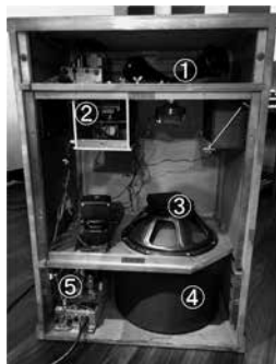
図 2.2.2 レスリースピーカーの断面図
