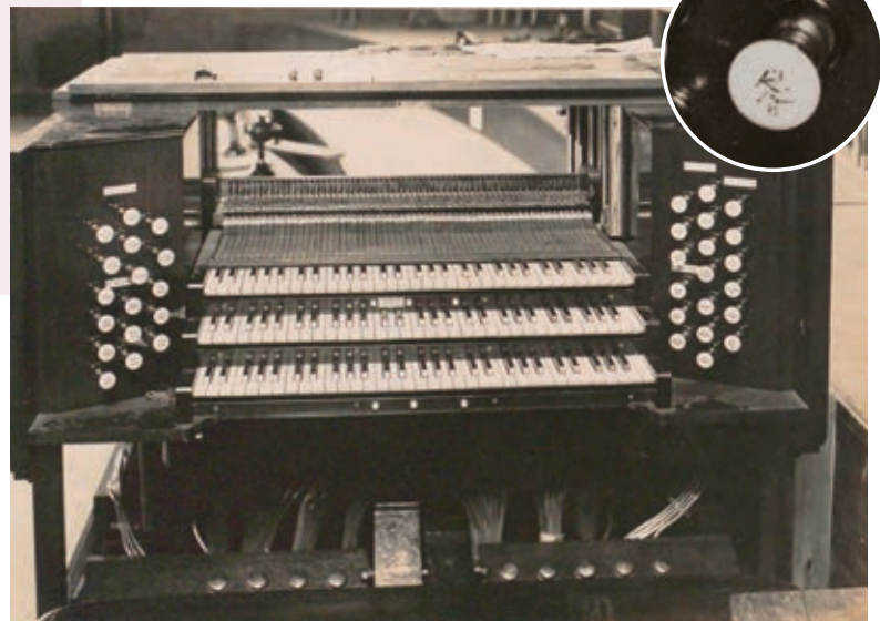
組み立て途中のコンソール（演奏台）。手鍵盤の両脇にあるノブのようなものは「ストップ（音栓）」といい、これを引くと様々な音色の音を選択できる。右の写真では、クラリネットやトロンボーンなどを模した音色のストップに交じり「尺八」と名付けられたものも見える。なお、南葵楽堂のパイプオルガンは、今日では珍しい「ニューマティック・アクション」という方式の機構を有し、個々の鍵の動きは送風管を通して空気圧で伝えられた。
