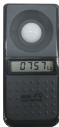
白い半球で光を感知し、モニターに数値が表示されます。
