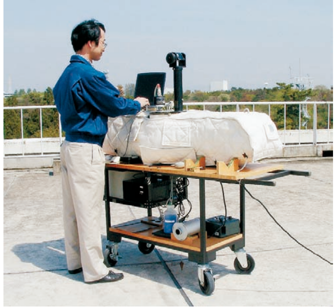
ドブソン分光光度計によるオゾン全量観測の様子
