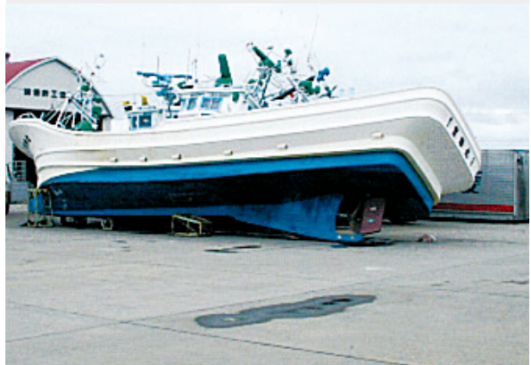
平成15年（2003年）十勝沖地震による上架中の漁船の転倒 （北海道豊頃町，平成15年9月28日撮影）
