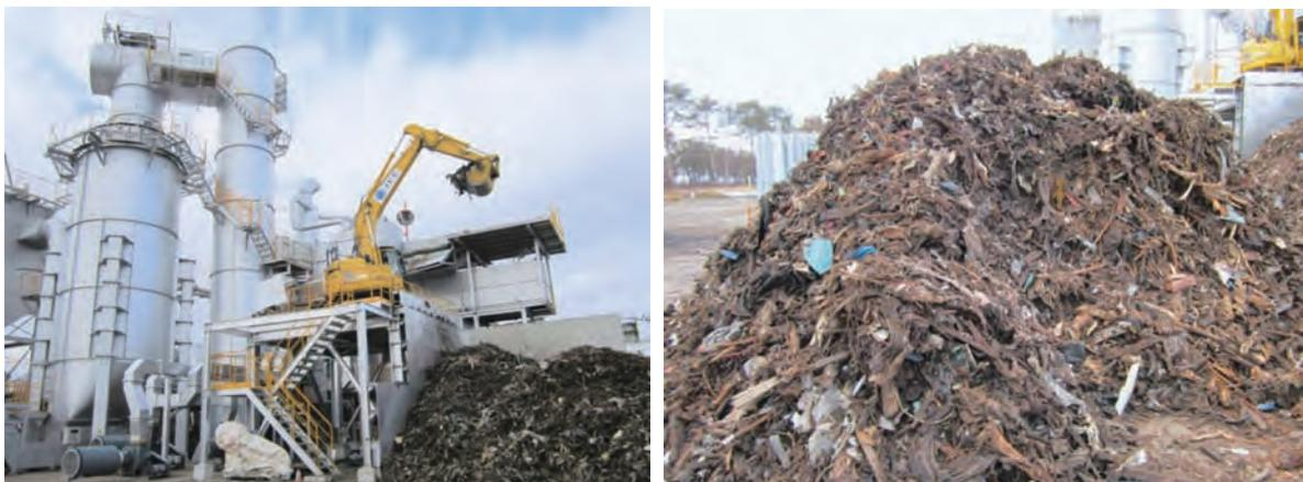
(注) 左の写真は仮設焼却炉(処理能力は90トン/日)で、24時間稼働している。右の写真は焼却するために破砕された可燃性の災害廃棄物。平成23年12月1日筆者撮影。
