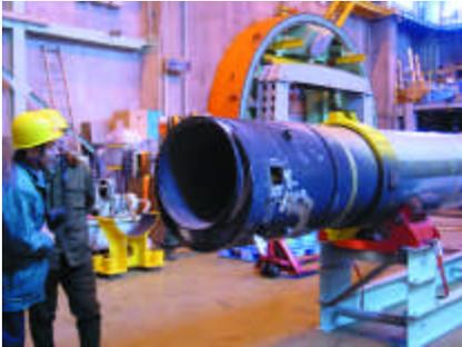
燃焼試験後のロケットモータ
