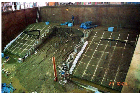
強化堤防の耐降雨実験
