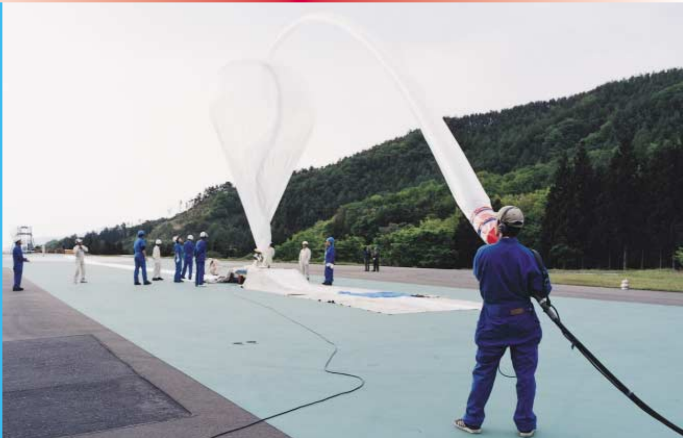
超薄膜型高々度気球 (BU60-1号機) の気球頭部よりヘリウムガスを注入している様子。放球場の先端に観測装置を保持している大型放球装置がある。(撮影:新倉克比古)
