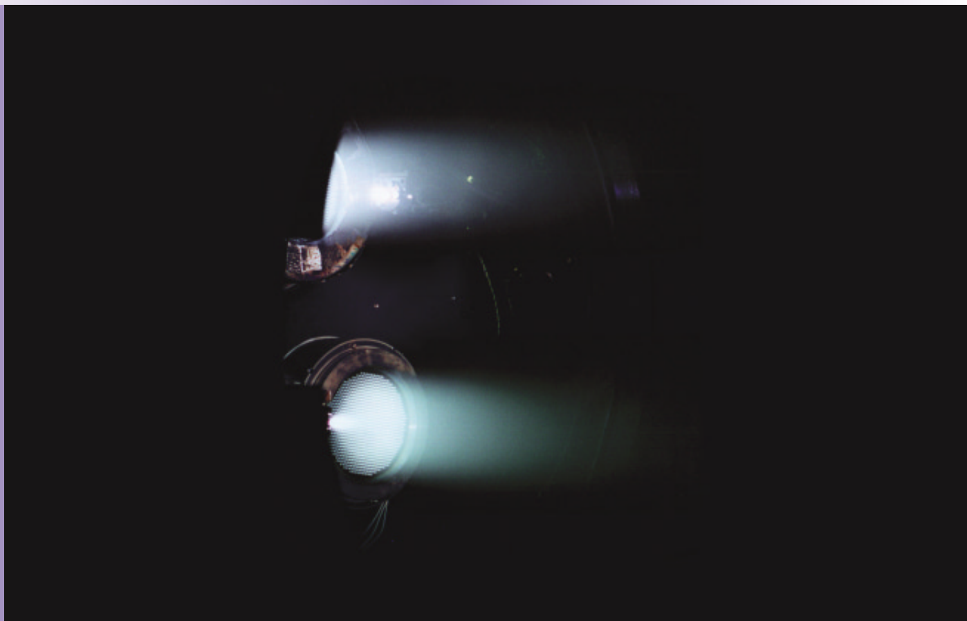
マイクロ波放電式イオンエンジンの2台同時作動（地上試験） 上：開発モデル，下：プロトタイプモデル
