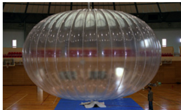
容積1万5000m 3 の圧力気球の3分の1相似形気球による耐圧試験
