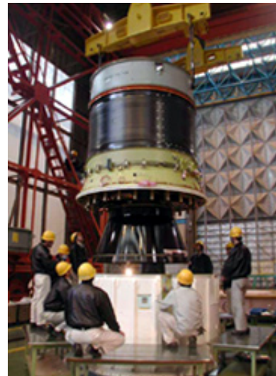
M-V-6号機の第2組立オペレーションの様子
