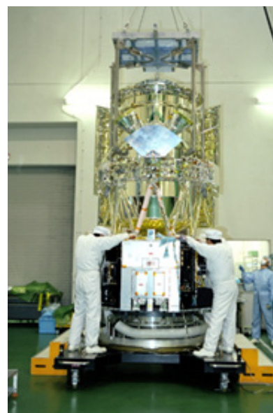
観測装置の衛星本体への組み付け
