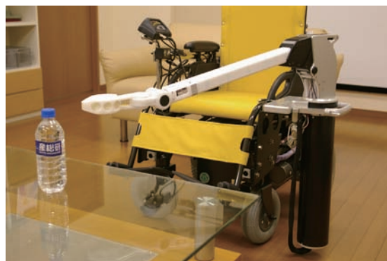
電動車いすに取り付けられたRAPUD（左）とテーブルに取り付けられたRAPUDでのユーザ評価実験（右）
