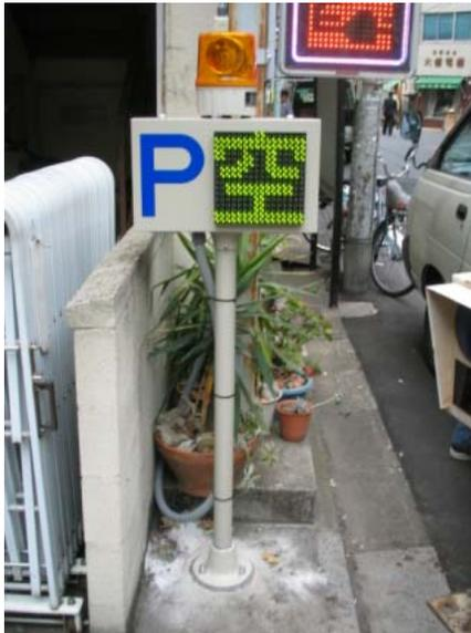
図-6 駐車場に設置された満空表示灯設置の例
