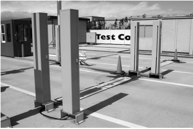
図4 2連の光センサから構成される車両検知器 車両の存在検知, 前後進判別を行う車両検知器構成.
