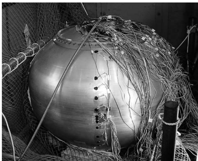
図5 サブスケールタンクによる加圧試験の様子 スピニング成形で製作したドームをFSWにより接合して組立したサブスケールタンクの加圧試験の様子を示す。
