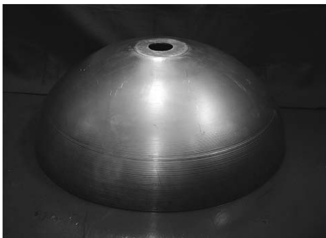
図8 ドーム試作品（直径900 mm） サブスケールサイズのドームをスピニング成形により試作した。
