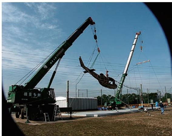
図6 試験セットアップー複合角落下試験
