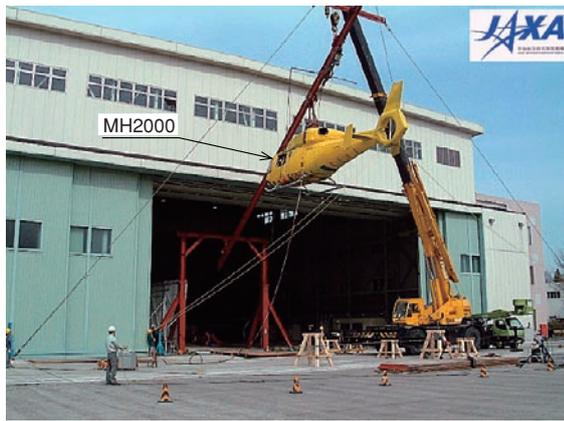
図2 MH2000 落下試験
