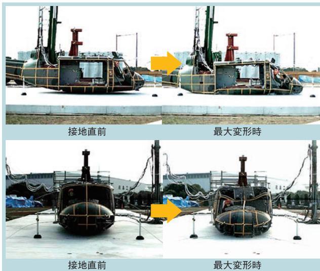
図8 落下時最大変形状況(垂直落下試験# 5:10.2m/s)
