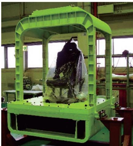
将来ヘリコプターの乗員生存性の向上に向けて、防衛省技術研究本部ではヘリコプター構造自体の耐衝撃性を向上させる「耐衝撃性構造の研究試作」に取り組んでいる。当社は、平成17年度に（その1）契約を受注、床下に搭載し落下時の衝撃エネルギーを吸収する衝撃吸収構造要素及び乗員空間を保持し乗員の安全を確保する保護殻構造を有する部分構造供試体を設計・製作し、平成20年3月に納入を完遂した。本報では、部分構造供試体設計のために実施した関連試験のうち、UH-1H用廃機8機を用いた既存ヘリコプターの全機落下試験について紹介する。
