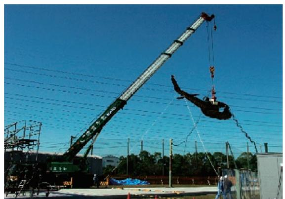
図5 試験セットアップー垂直落下試験
