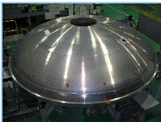
図3 実機成形ドーム(機械加工後)
