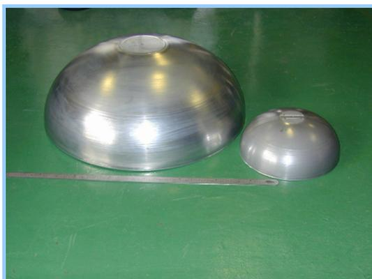
図2 社内試験研究で製造したスピニング成形ドーム(直径 900/400mm)
