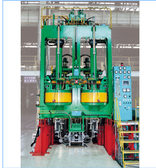
図4 油圧駆動式フレーム型加硫機 乗用車用、左右同時作動型
