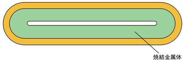
図1 従来型ヒートパイプの内部構造
